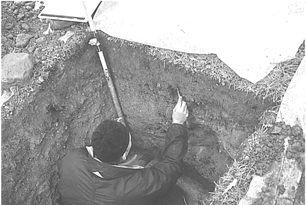
Abbildung 4: Bodenkundliche Praxis – Präparation einer Profilwand vor der bodenkundlichen Charakterisierung
