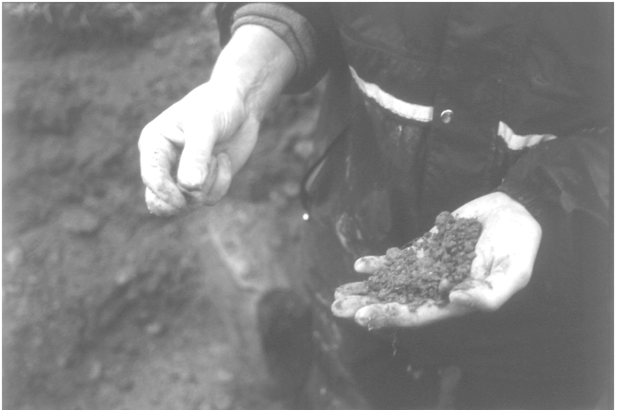
Abbildung 6: Mit der so genannten Fühlprobe wird die Bodenart an der Profilwand geschätzt
